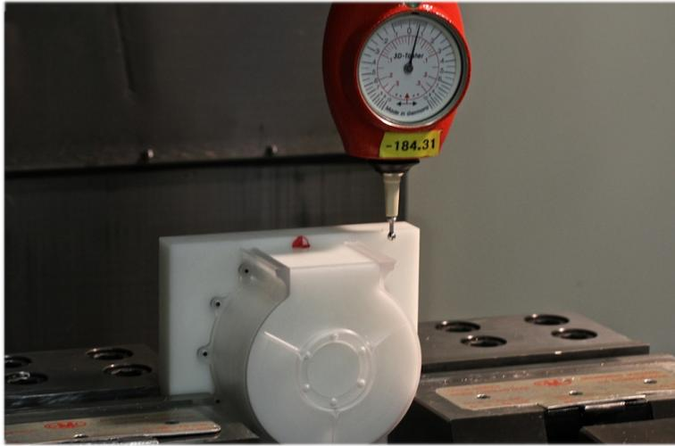
Danach wird die gesamte Lehre um 90° gedreht, um die letzte Bearbeitung zu ermöglichen.
