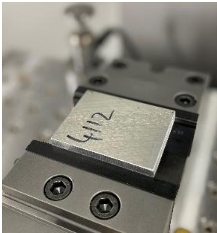
Abbildung 7 | Erste Spannung, Guideplate (231-4112)
